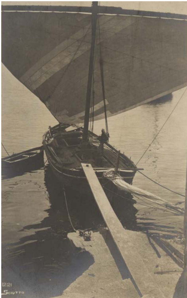
FOTOGRAFIA 59. Tartana de pesca; en podem veure el velam, que és l'element més característic d'aquest bastiment.
